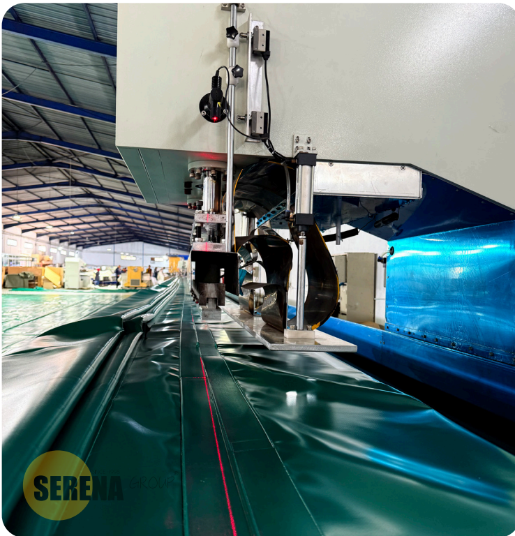
Máquina de soldadura de alta frecuencia sobre mesa de 30 metros de largo
